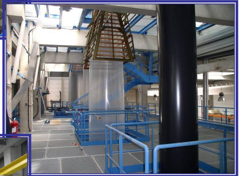
Extrusion/soufflage : partie haute
